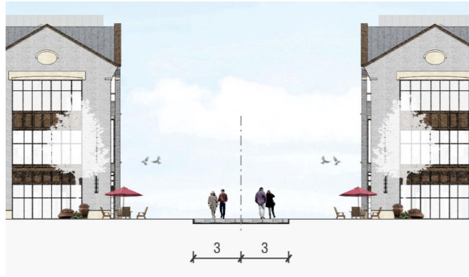
图 2.1-9 学校步道标准横断面图
